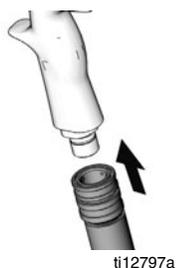
3. Заполните колпачок на 3/4 от его объема. Установите крышку. Защелкните крышку колпачка пистолета-распылителя для ее фиксации на сифонном колпачке. Смотрите руководство к распылительному пистолету HVLP *EDGE* касательно инструкций по эксплуатации.
