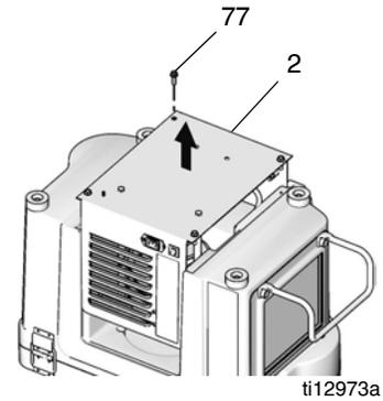
4. Вытащите вверх плиту основания распылителя и прикрепленные к ней детали. Пропустите провода электродвигателя, которые соединены с входным разъемом через отверстие в HVLP-коробке.
